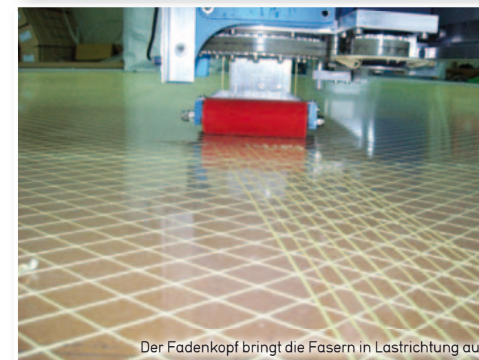
Fertig gelegte Fasern werden im Vakuumbett vorfixiert
